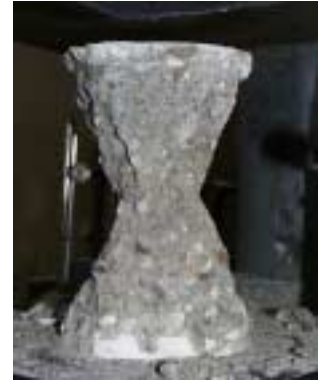
Fig. 2 Struttura resistente a prova ultimata
