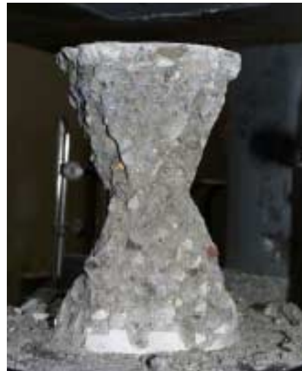
Fig. 8: Crack-path sperimentale in compressione
