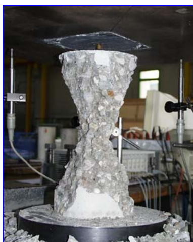
Figura 3.1.4. Cilindro tipo 2 della seconda serie dopo l'eliminazione del materiale degradato.
