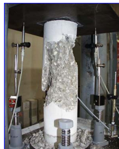
Figura 3.1.6. Cilindro tipo 5 della terza serie dopo l'eliminazione del materiale degradato.
