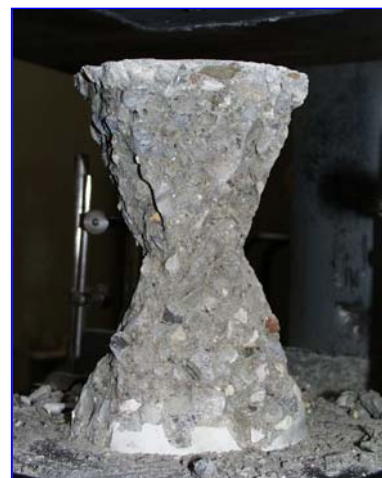
Figura 3.1.3. Cilindro tipo 1 della terza serie dopo l'eliminazione del materiale degradato.
