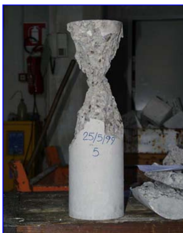
Figura 3.1.5. Cilindro tipo 5 della prima serie dopo l'eliminazione del materiale degradato.
